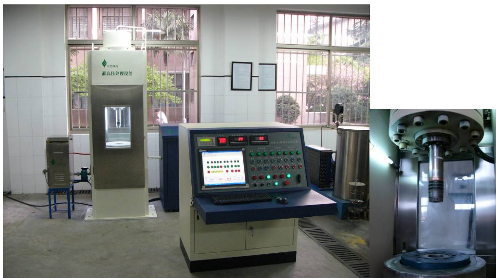
图3 小型超高压设备
